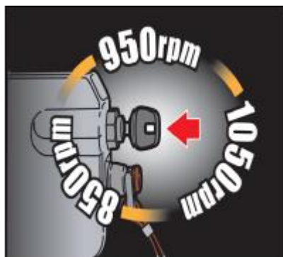
Μεταβλητό ρελαντί στα μοντέλα με χειριστήριο (EP-EPT)-(850-950-1050 σ.α.λ.)
